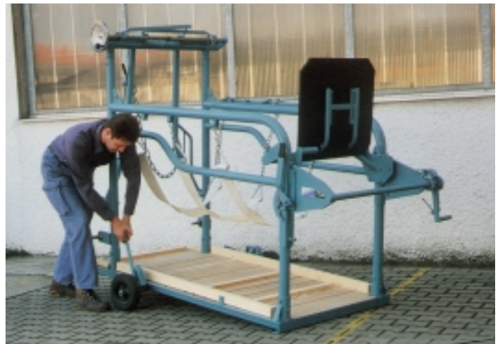
Typ T, mit Halsrahmenspindelverstellung, ansteckbare Laufräder 250 Ø, Vollgummi mit Handhebevorrichtung zum Transport des Gerätes von Hand im Hofbereich
