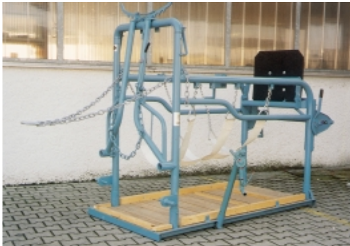
Typ T, mit Vorderfußwinde, Hinterfußwinde und Dreipunktkette
